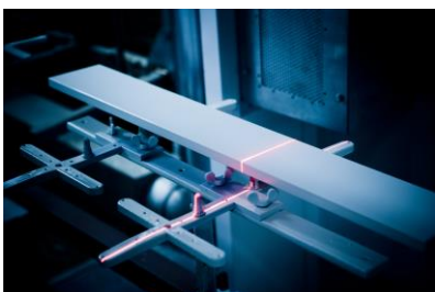
■ Die Komponenten werden daraufhin in die Lackieranlage gefördert und in dreidimensionalem Format gescannt.
